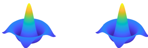
图 4 新的五次Catmull-Rom插值基函数列 \bar{\varphi}_{i,5}(t) 插值重建墨西哥草帽曲面, 左边原始墨西哥草帽曲面, 右边新的五次Catmull-Rom插值基函数列 \bar{\varphi}_{i,5}(t) 插值重建墨西哥草帽曲面图
